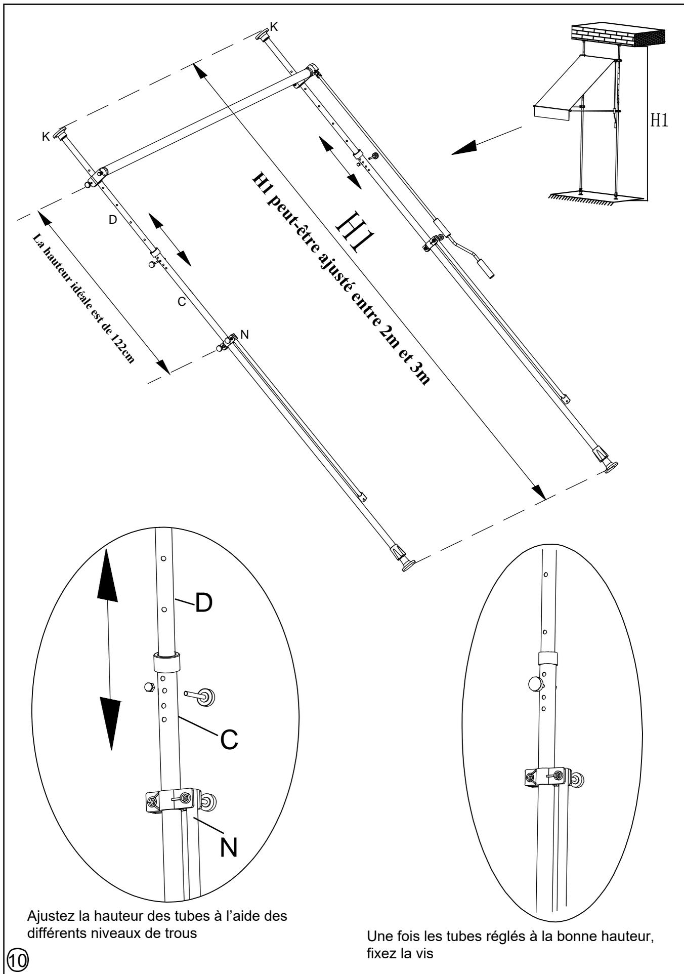
Ajustez la hauteur des tubes à l'aide des différents niveaux de trous
