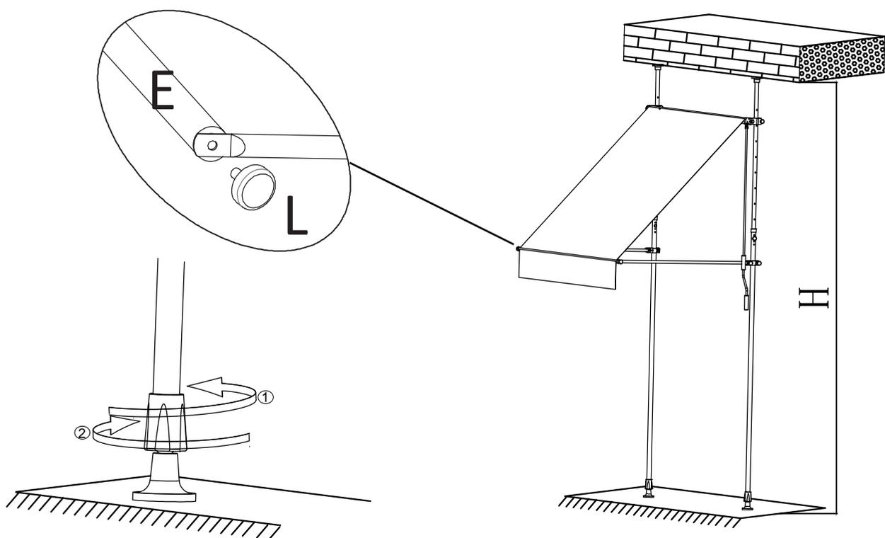
Faites pivoter la manivelle pour ajuster la hauteur d'1,5cm
